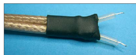
Bild 3: Selbst hergestellte 100-Ω-Leitung
