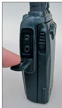
Zwei Klinkenbuchsen für Lautsprechermikrofone oder Anschluss eines Programmieradapters
