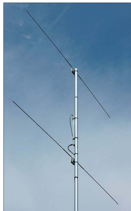
Bild 3: Die gestockte Zweiergruppe im Einsatz, in der Mitte ist der Anpasstopf erkennbar.
