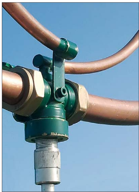
Bild 5: Einkopplung unter Verwendung eines T-Stücks; ein Ende der Koppelschleife ist hier geerdet.
