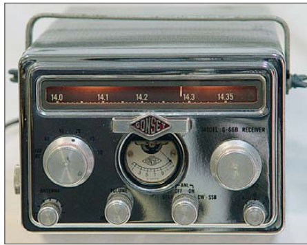
Bild 5: Der Transceiver war noch nicht erfunden. Passend zum Sender hier der Empfänger G-66B [7], äußerlich identisch mit dem von DL9HF verwendeten G-66. Als Doppelsuper konstruiert, enthielt er zusätzlich den Bereich von 0,54 bis 2,0 MHz zum Empfang des Mittelwellen- und 160-m-Bandes.
