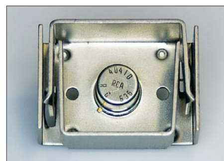
Bild 3: RCA 40410 mit am Gehäuse angepresstem Kühlblech – mni tnx DJ3VY!
