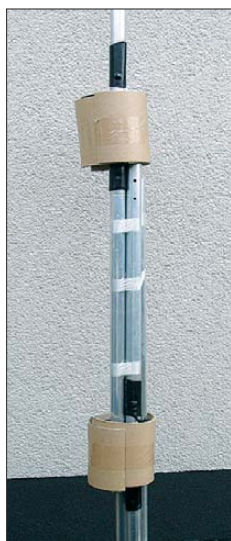
Bild 2: Die Spulen sind während des Transports vor einer Verformung geschützt.
