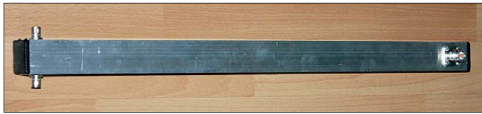
Bild 4: Der fertige Topf, Enden mit handels- üblichen Möbelfüßen abgeschlossen
