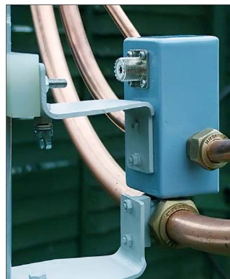
Bild 6: Einkopplung ohne galvanische Verbindung Fotos: DL3AYJ (3), M0BDQ (1), Screenshot: Red. FA
