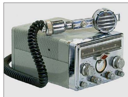
Bild 2: Der Sender Gonset G-77 [4] – sehr kompakt, anodenmoduliert, für AM, CW und alle fünf Bänder von 80 m bis 10 m; mit einer Endröhre des Typs 6146 [5] bestückt, lieferte er etwa 30 W Sendeleistung.
