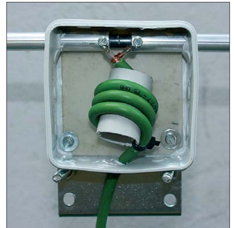
Bild 9: Blick in die geöffnete Dipoldose mit der Speisedrossel
