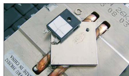
Bild 4: Defekter Widerstand auf einem Kühlkörper mit Strommarken Fotos: DL7LA
