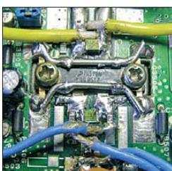
Bild 1: Modifizierte UHF-Endstufe des FT-100 mit dem neu eingebauten MRF1570FNT
