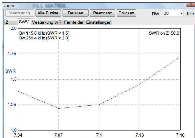
Bild 13: Die durch Simulation ermittelte Bandbreite deckt sich fast genau mit den realen Messergebnissen.
