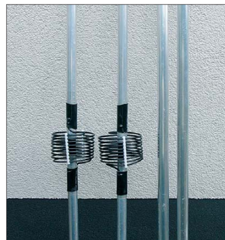
Bild 4: Der Dipol besteht aus Rohren mit 35, 30, 25, 20, 16 und 12 mm Außendurchmesser.
