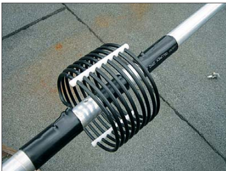
Bild 6: Die High-Q-Spulen sind frei tragende Luftspulen mit einem Durchmesser von 13,5 cm und einer Länge von 8,5 cm, welche durch Kunststoffstege in Form und Abstand gehalten werden. Sämtliche Übergänge sind mit Schrumpfschlauch abgedichtet.
